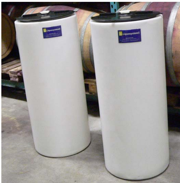
Abb. 4.24: Reifetanks der Firma Liquosystems im Einsatz (Foto: Durner)
