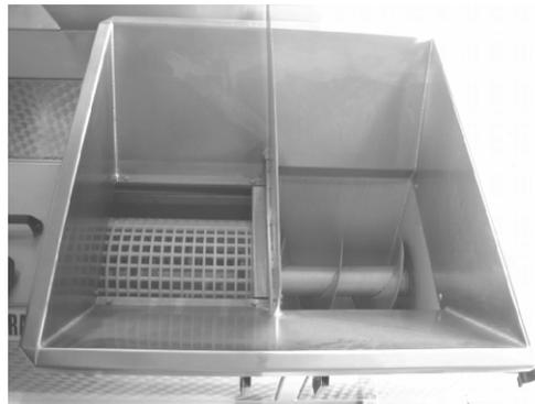
Abb 32: Geteilter Trichter bei Zickler-Rauch zum Vorbeiführen am Abbeerzylinder
