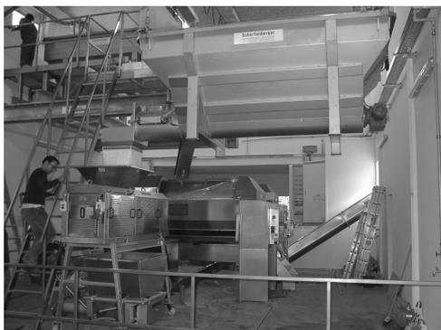
Abb. 14: Neubau eines Kelterhauses mit Portalkran zur Beschickung der Pressen und Maischebehälter
