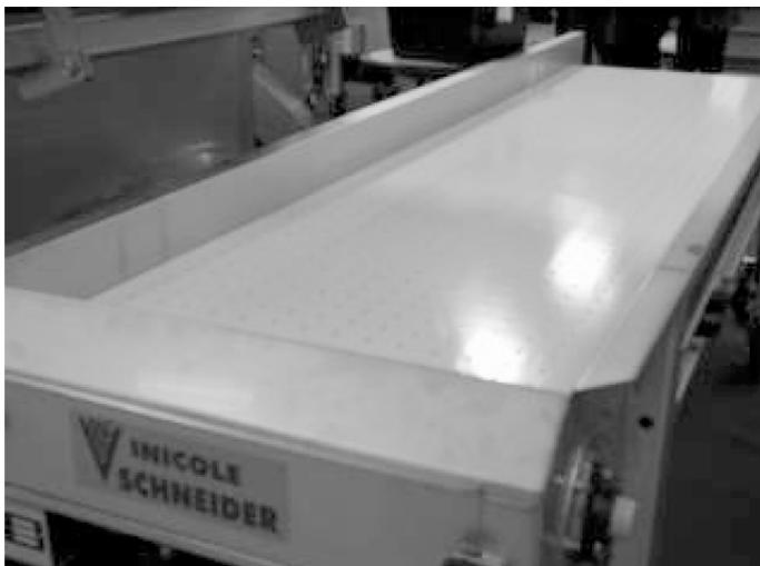
Abb. 59: Sortiertisch mit gelochtem Band von VINICOLE SCHNEIDER
