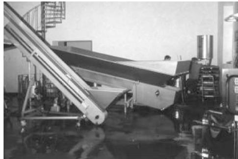
Abb. 62: Schrägförderer zur Aufnahme und Verteilung großer Mengen
