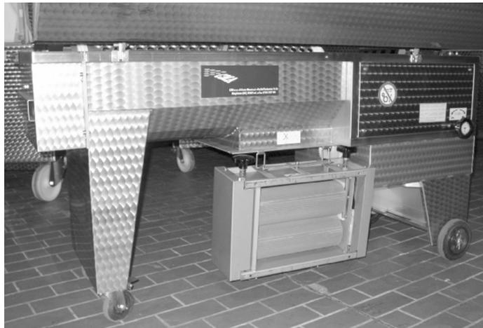
Abb. 44: Ausgeklappte Quetscheinrichtung bei der Abbeermaschine von CMA
