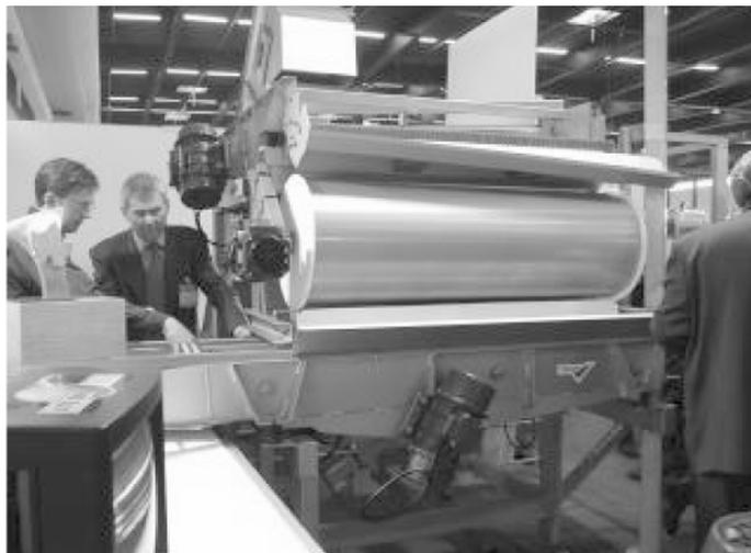
Abb. 61: Automatische Sortiermaschine TRIBAI von ATESN
