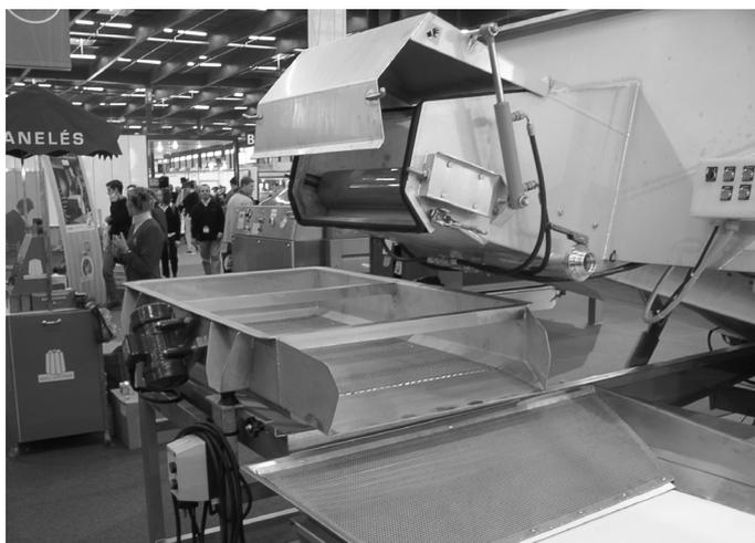
Abb. 5: Neuer Traubenwagen von AGRIFOY mit Bandförderung und Möglichkeit der Schrägförderung durch Anheben des Hecks
