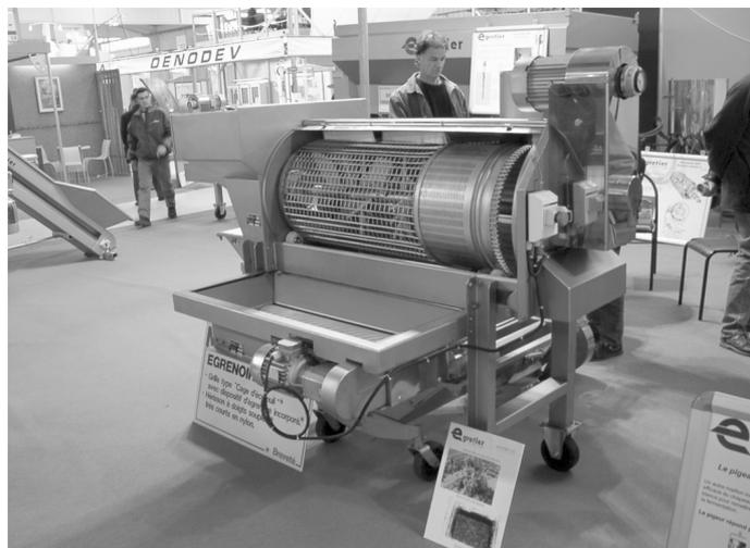
Abb. 45: Breite ausklappbare Walzen bei der Abbeermaschine von EGRETIER
