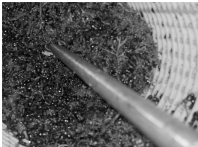
Abb. 53: Typische Verstopfung der Maschine im vorderen Bereich des Korbes
