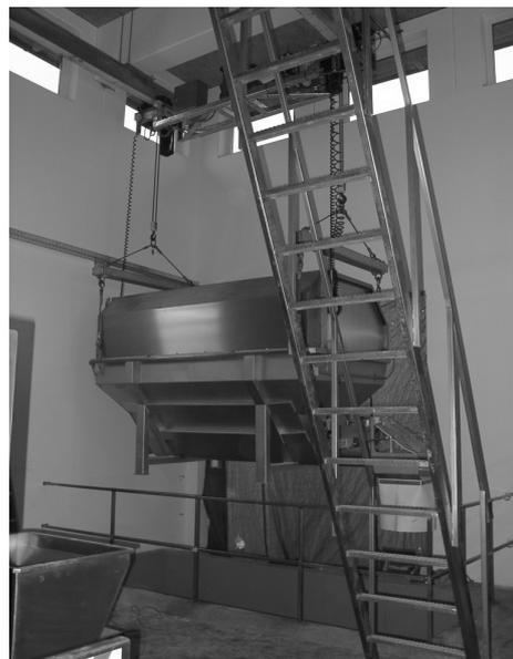
Abb. 15: Annahmebehälter am Portalkran des Kelterhauses (s.a. Abb. 13)
