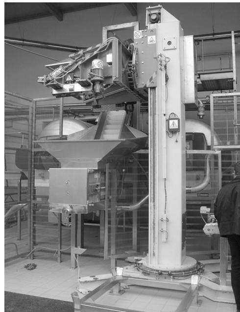
Abb. 11: Automatische Kippvorrichtung zu Verarbeitung von halben Boxpaletten in der WG Tramin/Südtirol
