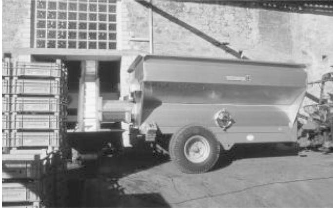
Abb. 64: Abladen vom Traubenwagen mit Schnecke auf Förderband
