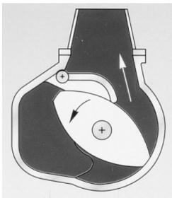
Abb. 68: Schnitt durch eine Drehkolbenpumpe
