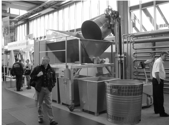
Abb. 10: Einheitsbehälter aus Edelstahl zur Traubenannahme (STRIEGEL, Hecklingen)
