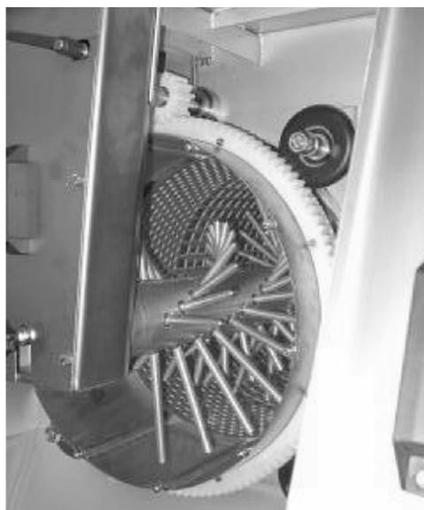
Abb. 48: Zahnkranz und Antriebsritzel bei AMOS
