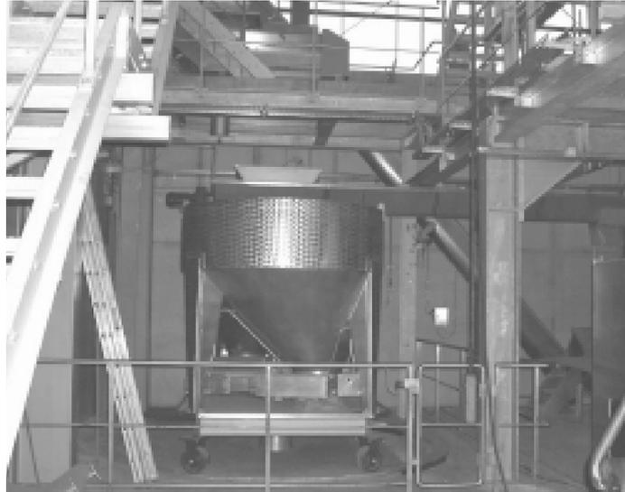
Abb. 16: Fahrbarer Behälter, vorbereitet zum gleichzeitigen Hub mit Portalkran
