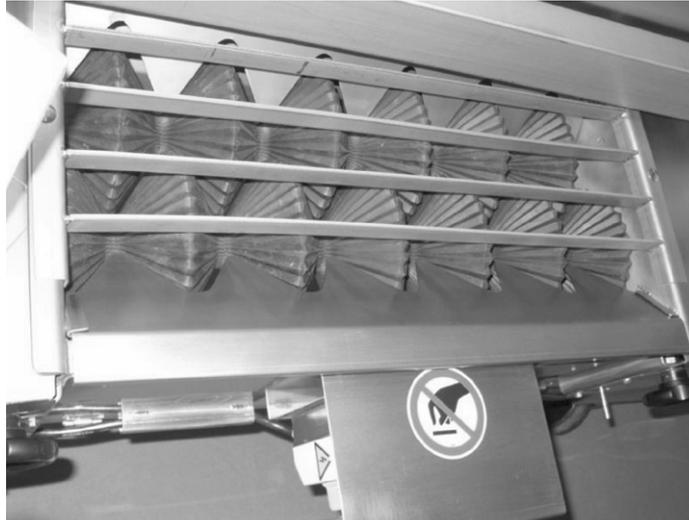
Abb. 43: Ausklappbare Quetscheinrichtung bei DEMOISY. Die Walzen haben hier eine konische Form, die zwar wirksam arbeiten, wegen der unterschiedlichen Umfangsgeschwindigkeiten jedoch auch mazerierende Effekte zeigen.
