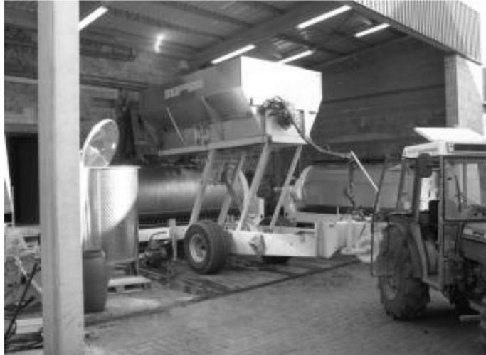
Abb. 3: ZICKLER-RAUCH Traubentransporter mit Hub beim Abladen
