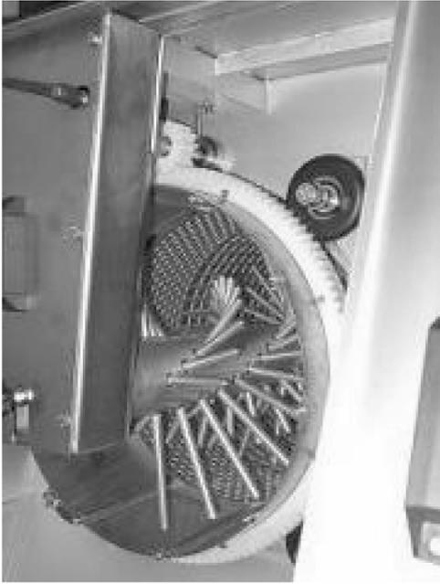
Abb. 36: Zentrische Stiftwelle bei der Abbeermaschine von AMOS
