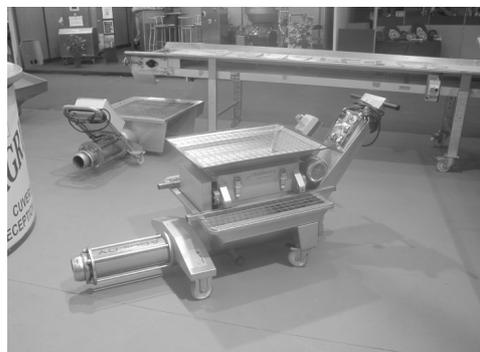
Abb. 66: Exzenterschneckenpumpe mit aufgesetzter Quetscheinheit zur Kombination mit einem Sortiertisch
