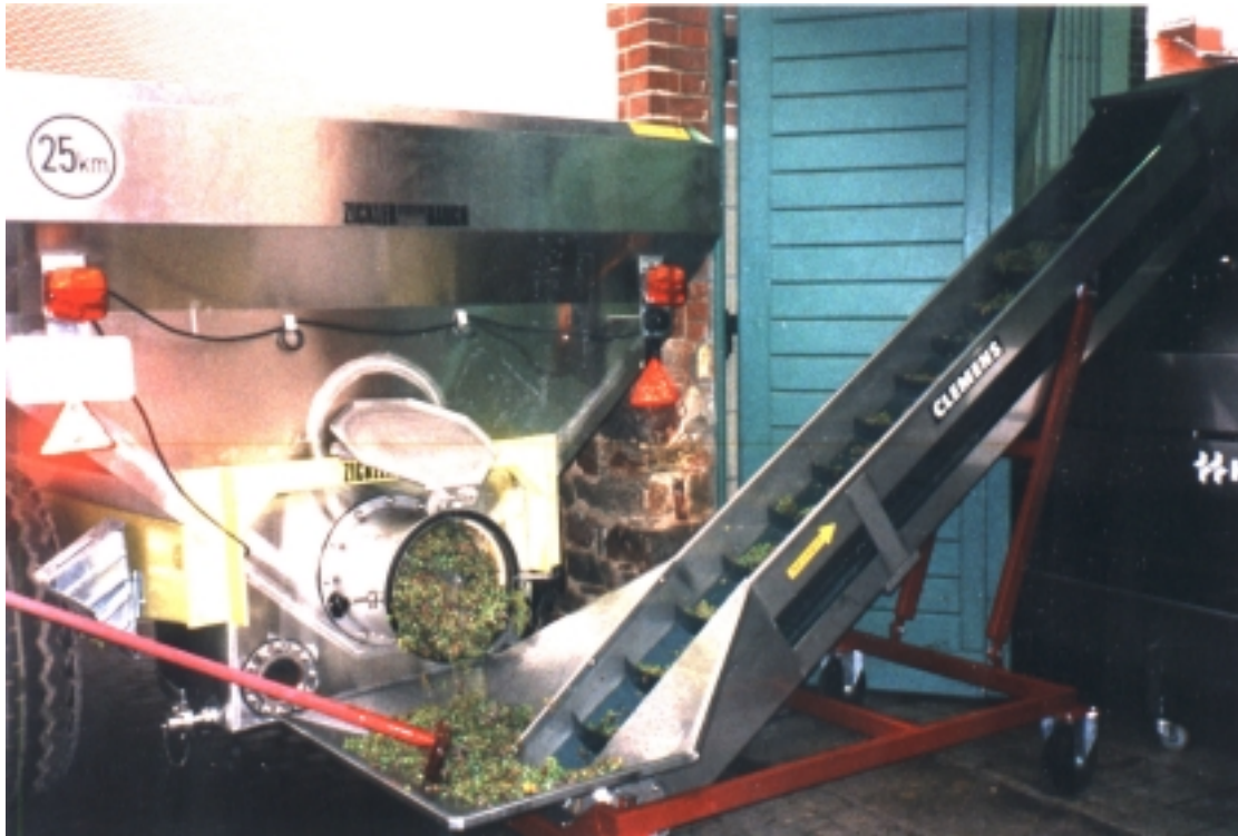
Abb. 7: Traubentransportband beim Befüllen der Presse aus dem Transportwagen
