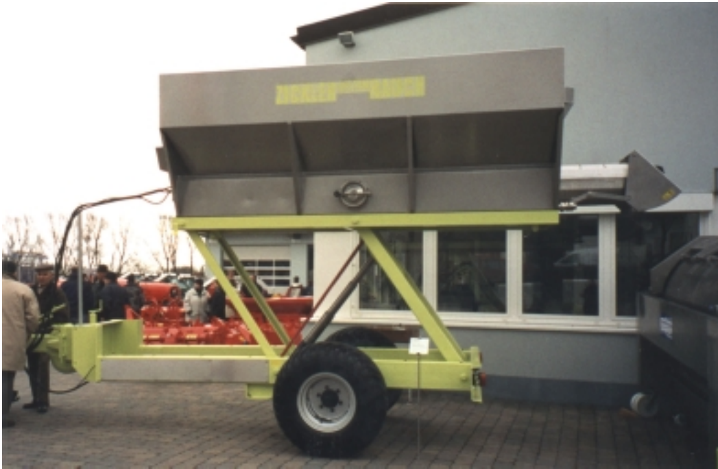
Abb. 5: Schneckenentladewagen mit Hubeinrichtung
