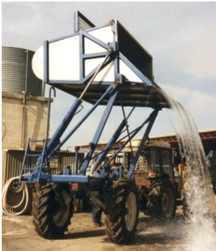
Abb. 6: Überladekipper für Maschinenlese in Australien
