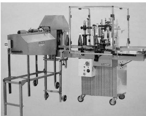
Abb. 11: Cleanat und Get-Up mit Etikettiermaschine
