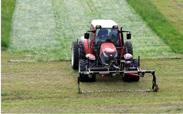
Abb. 3: Doppelmessermähwerk als Front-Heck-Kombination (© BB – Umwelttechnik)
