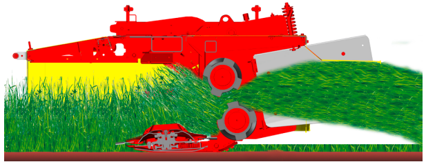
Abb. 4: Walzenaufbereiter im Querschnitt (©Pöttinger Landtechnik GmbH)
