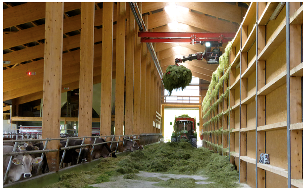
Abb. 1: Boxentrocknung mit Kran – hier kann der Kran zur Einlagerung und zur Futtervorlage verwendet werden (© B. Meili)
