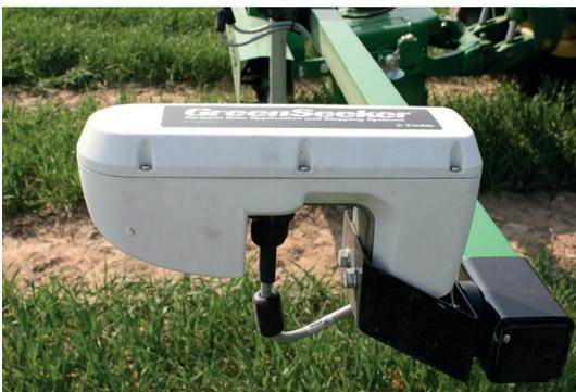
Abb. 10: GreenSeeker-Messkopf (Quelle: Drücker)
