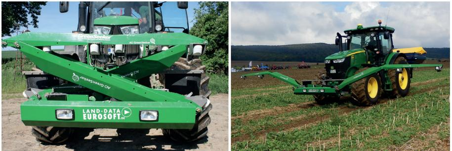
Abb. 9: GreenSeeker-Stickstoffsensoren im ein- und ausgeklappten Zustand im Frontanbau (Quelle: Drücker)
