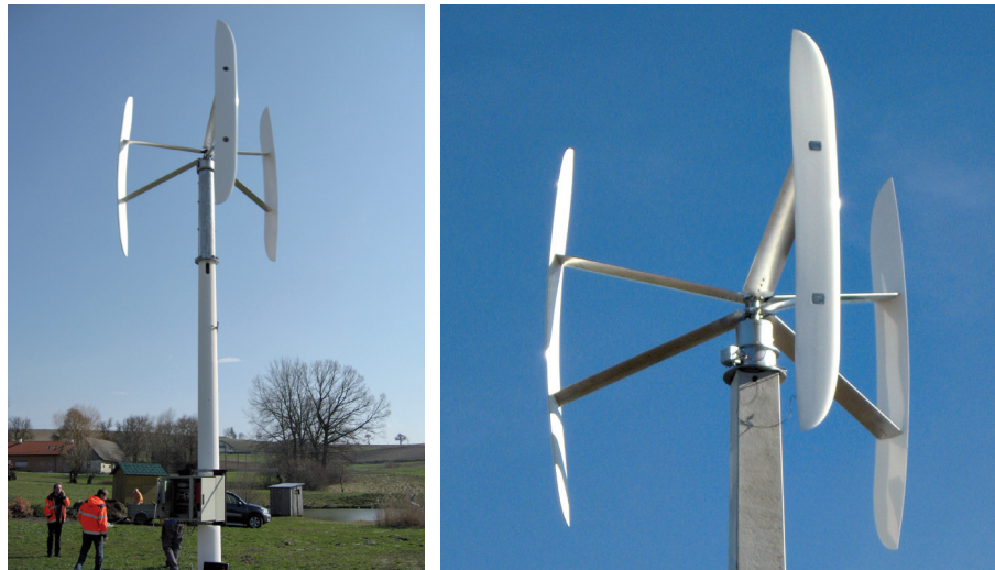
Abb. 3: Kleine Windenergieanlage mit vertikaler Achse (Fotos: Silent Future Tec GmbH)
