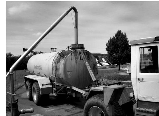
Abb. 14: Befüllung eines Pumpentankwagens an der Kläranlage
