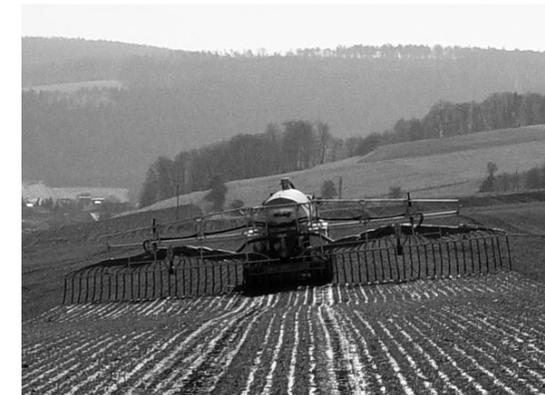
Abb. 15: Klärschlammabfuhr mit Schleppschlauchverteiler
