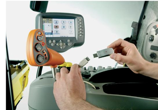
Abb.11: Ertragsdaten werden im Ertragsmonitor des Mähdreschers aufgezeichnet und nach der Ernte mithilfe von Speichermedien wie einem USB-Stick auf den PC übertragen (Werkfoto New Holland)
