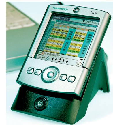
Abb. 3: Mit dem Cradle (Wiege) werden Daten zwischen PDA und PC ausgetauscht und der PDA aufgeladen (Werkfoto Palm)
