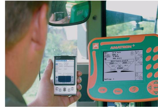
Abb. 1: Ein PDA kann als Informationsspeicher und Instrument zur Produktionssteuerung eingesetzt werden (Werkfoto agrocom)
