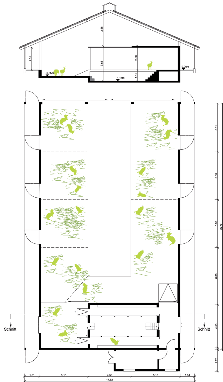
Abb. 4.1: Neubau eines Tiefstreustalls für 142 Ziegen
