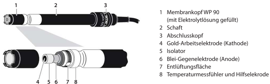
Abb. 5: Messfühler WTW Cellox 325 (Quelle: WTW 2011, verändert)
