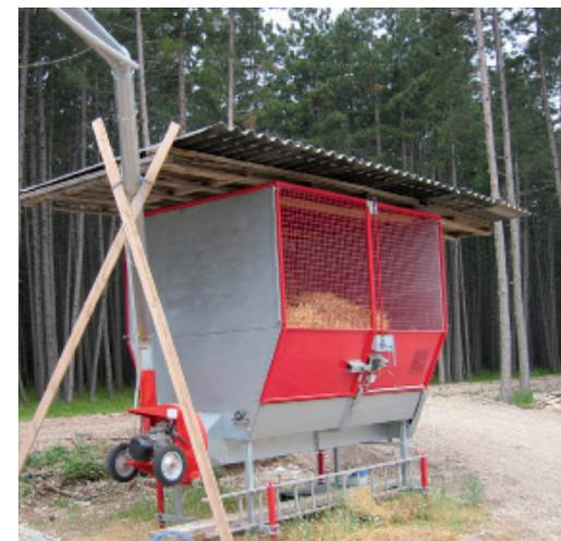
Abb. 5.4: Stroh wird außerhalb des Stalls gelagert, gereinigt, entstaubt und über ein Rohrleitungssystem in den Stall transportiert (Foto: J. Herrle)
