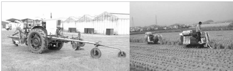
Abb. 3: Autonome Landmaschinen: Wendepflug Eicher AgriRobot von 1964 (links) und Folgesteuerung bei Reismähdrescher (rechts) (FieldRobot Event, Umeda 2010)
