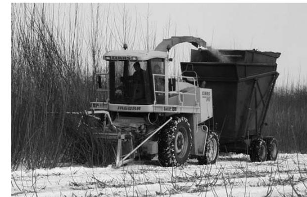
Abb. 4: Feldhäcksler mit Gehölzschneidwerk und Hochkipper bei der Weidenernte
