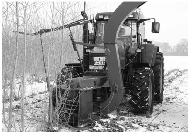
Abb. 5: Prototyp des einreihigen Anbau-Mähhackers bei der Pappelernte
