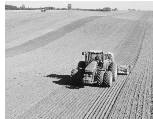
Abb. 1: Traktor mit AutoTrac beim Säen ohne Spurreißer
