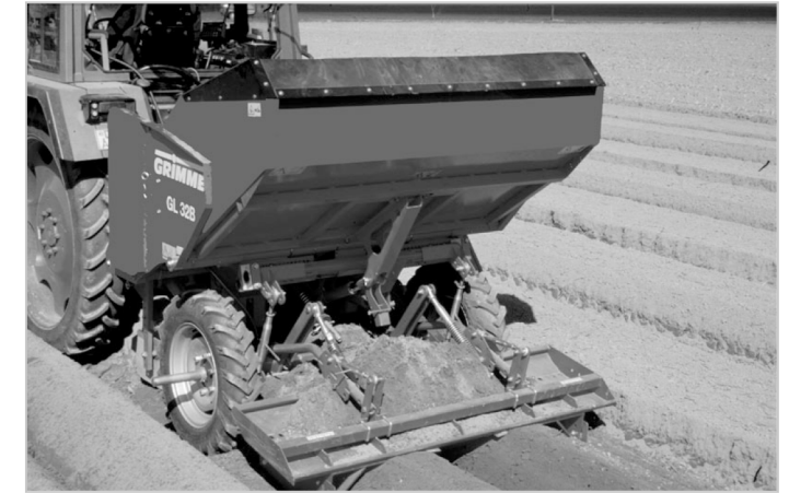
Abb. 19: Spurweite und Reifenbreite des Traktors müssen auf die Beetbreite abgestimmt sein
