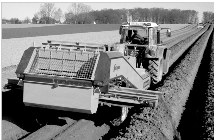
Abb. 16: Separierer mit mehreren Siebketten zur Beimengungsabtrennung
