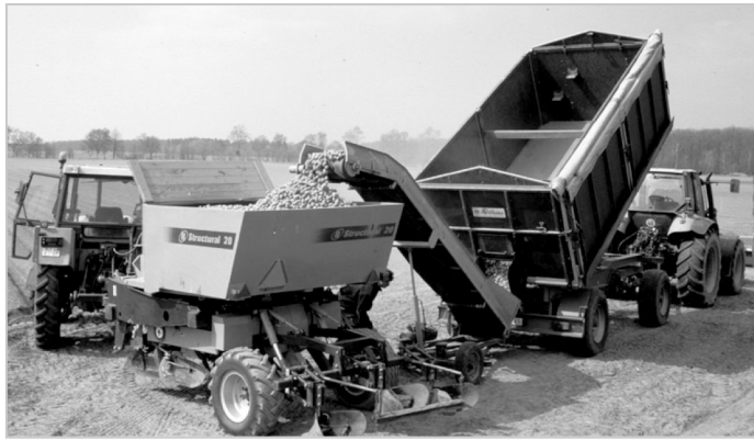
Abb. 18: Pflanzgutbefüllung bei einer angehängten Legemaschine mit 3-t-Bunker über ein Förderband
