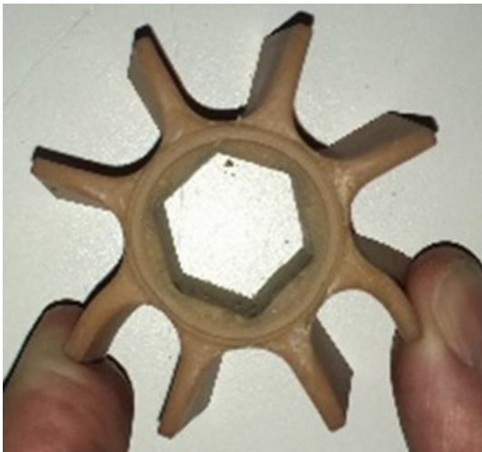
Abb. 2: Elastizität des Flex-20-Zellenrades – 20 steht für 20 mm (© Scheidweiler/HGU)
