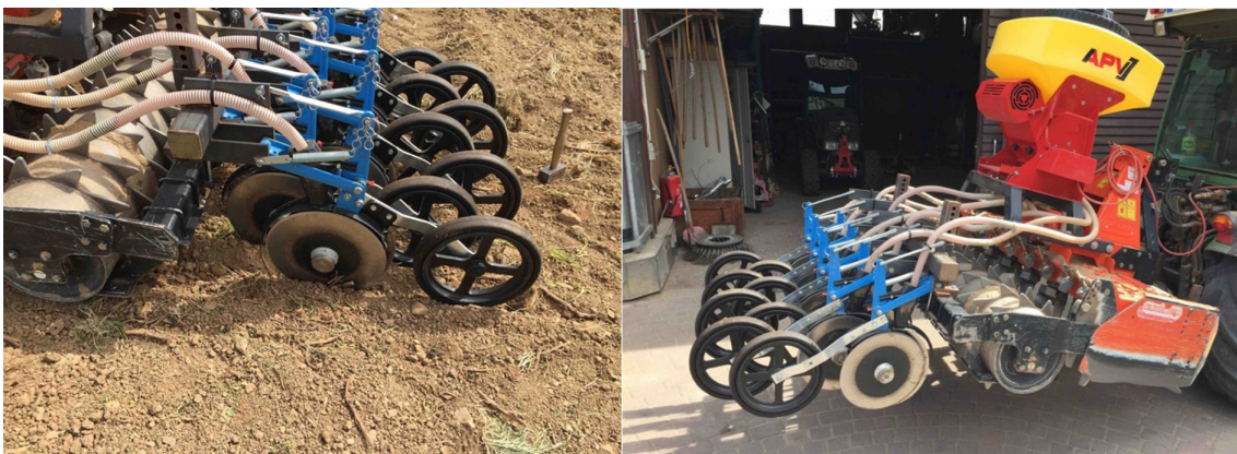
Abb. 1: Prototyp der Drillmaschine mit Doppelscheibenscharen angebaut an eine Kombination aus Kreiselegge und Säaggregat (© Scheidweiler/HGU)
