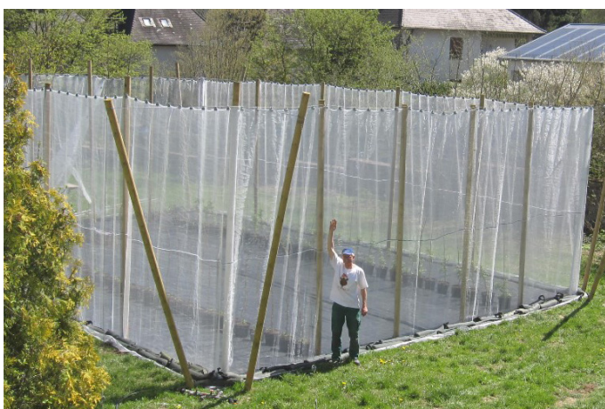
Abb. 3: Versuchsanlage mit einer 4 m hohen Seitenwand; bespannt mit einem feinmaschigen Netz (© A. Fried)
