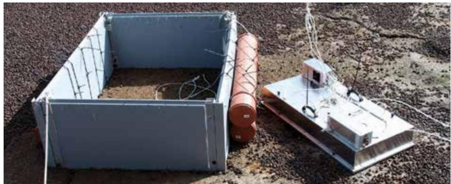
Messungen der Emissionen in einem Güllebehälter mit mineralischer Schwimmdecke
