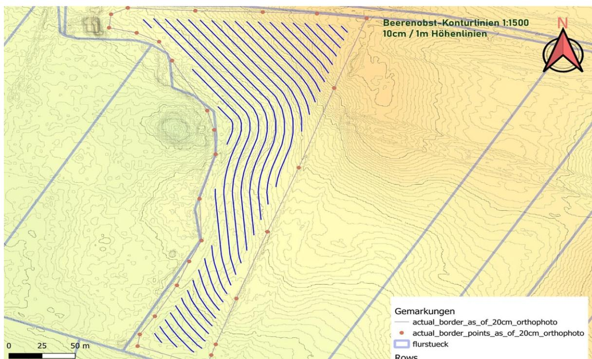
Abbildung 1: GIS-Planung des Systems entsprechend der örtlichen Topographie
