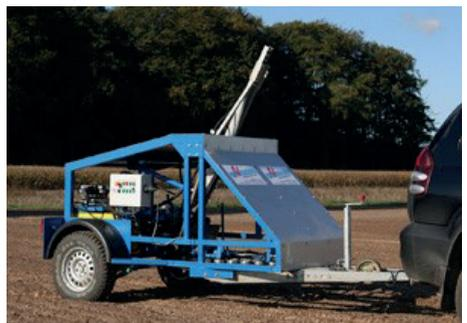
Abb. 6: Bodenbeprobungsgerät: Speedprob gezogen vom Geländewagen; Entnahmeprinzip: stechend (Quelle: Nietfeld GmbH)
