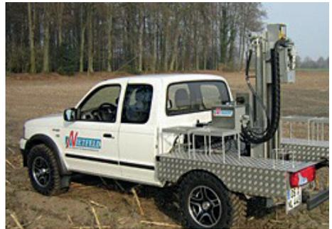
Abb. 5: Bodenbeprobungsgerät: Duoprobe 60 in einen Pick-up integriert; Entnahmeprinzip: schlagend (Quelle: Nietfeld GmbH)
