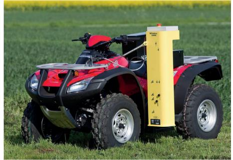
Abb. 4: Bodenbeprobungsgerät: Wintex 1000, Entnahmeprinzip: hydraulisch drückend (Quelle: Wintex Agro)
