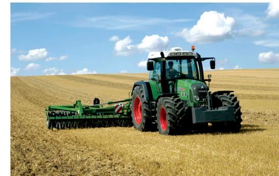
Abb. 1: Die konstruktiv mögliche Arbeitsbreite von Arbeitsgeräten kann mit einem Parallelfahrssystem fast vollständig genutzt werden (Werkfoto Fendt)
