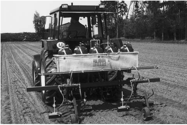
Abb. 7: Abflamngerät für Reihen- und Flächenbehandlung Werkfoto: Reinert
