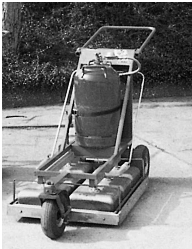
Abb. 6: Handgeführtes Karren-Infrarotgerät Werkfoto: Werner
