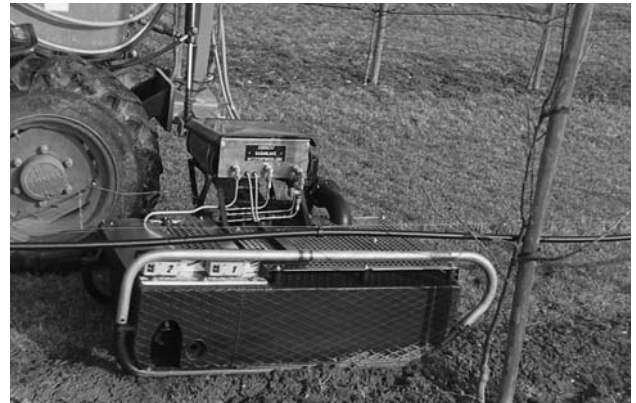
Abb. 9: Abflamngerät für die Baumreihenbehandlung mit zwei Infrarot-Reflexionslichttastern für die Steuerung der Seitenbrenner Foto: Rannertshäuser
