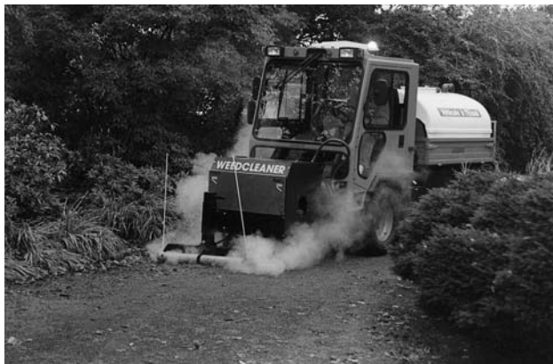
Abb. 3: Wasserdampfergerät für kommunale Einsätze Werkfoto: Görgens
