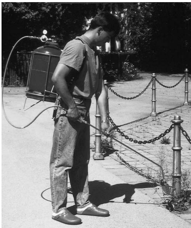
Abb. 4: Handgerät mit Rückentrag für die Gasflasche Werkfoto: Reinert
